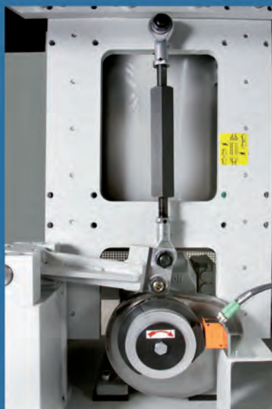
Tischhub kurvengesteuert über Linearführungen
