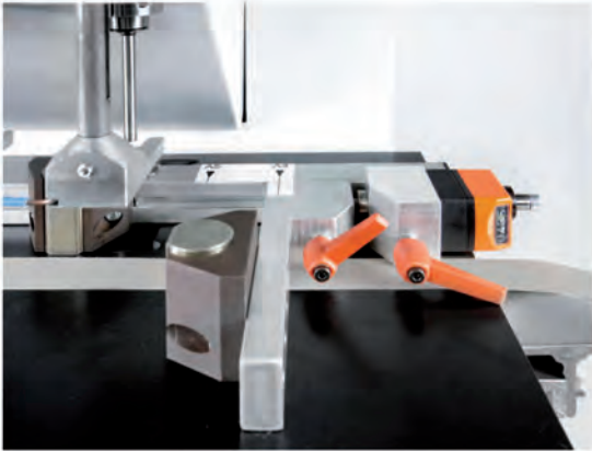
Tiefen- und Seitenansläge für Feineinstellung mit Positionsanzeige und „Null-Spalt“
