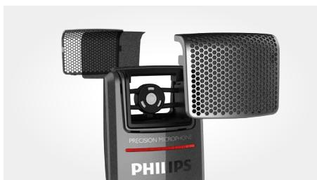
Die speziell entwickelten sechseckigen Öffnungen der Metallabdeckung bieten eine dreimal größere offene Oberfläche als beim Vorgängermodell und sorgen so für kristallklare Aufnahmen. Vliesstoff ober- und unterhalb der Mikrofonkapsel filtert Klangverzerrungen, wie Pop- oder Zischgeräusche, heraus und ermöglicht perfekte Aufnahmelergebnisse selbst beim Diktieren nah am Mikrofon.
