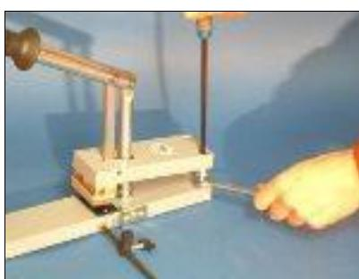
Die Parallelität kann durch die zwei hinteren Schrauben eingestellt werden. Lösen Sie die M8 Muttern mit einem Schraubenschlüssel 13 mm und stellen Sie die Schrauben mit einem Imbusschlüssel 6 mm ein. Nach erfolgter Einstellung befestigen Sie die Muttern.
