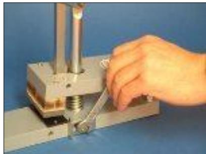
Packen Sie die MP-1 Handstanze aus, und montieren Sie das Gerät.
