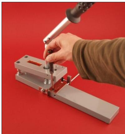
Die VMP-1 Schneidplatte ist mit zwei M3 Schrauben befestigt. Nach deren Entfernung können Sie die Schneidplatte herausnehmen.
