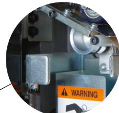
Vereinfachte Materialzuführung durch ein nach vorne gelegtes zusätzliches Hebelsystem.
