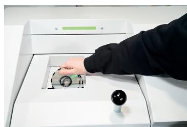
Schmale optische, magnetische und elektronische Datenträger können bequem und zeitsparend über eine Eingabeöffnung direkt vernichtet werden.
