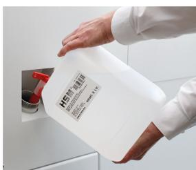
Für konstant hohe Schnittleistung und -qualität ist ein automatischer Öler integriert.
