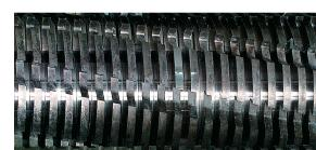
Die induktionsgehärteten Vollstahl-Schneidwellen sind unempfindlich und garantieren Langlebigkeit.
