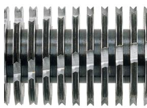
Die induktionsgehärteten Vollstahl-Schneidwellen garantieren Langlebigkeit.
